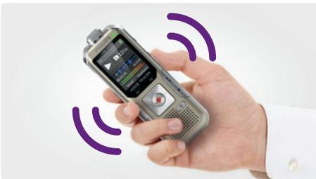
Il sensore di movimento incorporato riconosce se il registratore è appoggiato sul tavolo o è tenuto in mano e seleziona la sensibilità del microfono adeguata alla situazione di registrazione in modo da evitare di bloccare accidentalmente l'audio che si desidera registrare.
